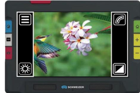
Anzeige von virtuellen Tasten bei Verwendung der Vergrößerungskamera im erweiterten Modus.
