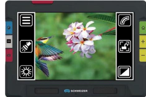
Anzeige von virtuellen Tasten bei Verwendung der Übersichtskamera im erweiterten Modus.
